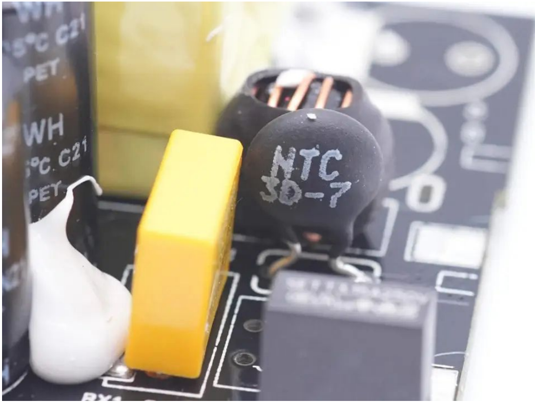
NTC浪涌抑制电阻用于抑制上电浪涌电流。
